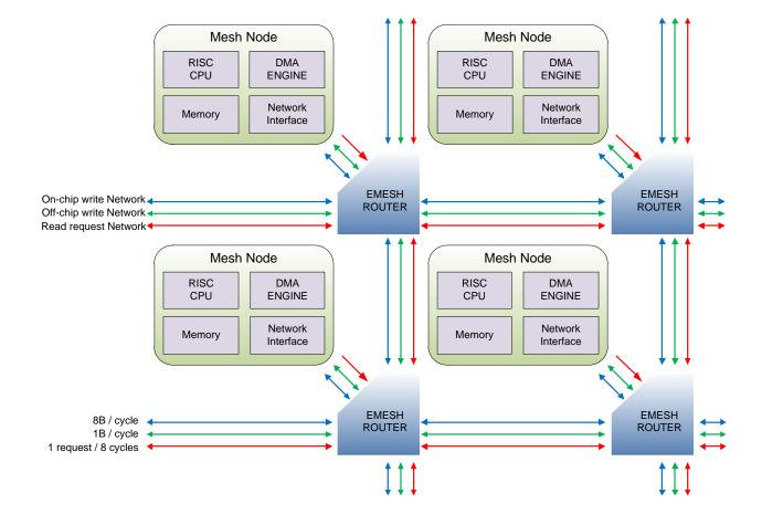
Figure 2: eMesh<sup>™</sup> Network-On-Chip Overview
